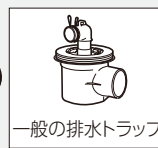
排水経路が狭い排水トラップの例
