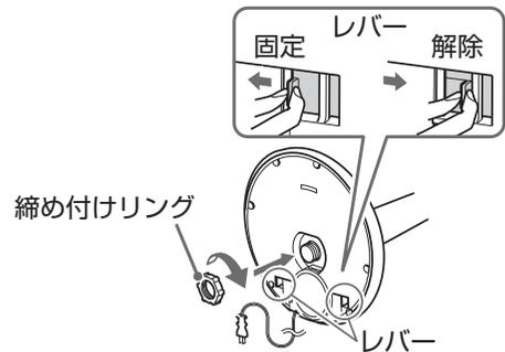
③締め付けリングを右方向に回し、しっかり締
