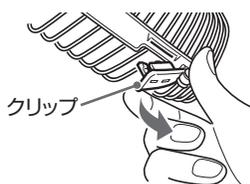
②ガードリングを両手で手前に引くようにして、前ガードをはずす（クリップを引っ張ると破損の原因になります）（→ 7 ページ 手順 4）
