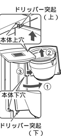
ドリッパー枠を矢印の方向に押し上げ突起(下)を浮せ矢印の方向へ引っ張りながらはずします。
