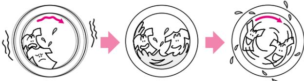
片寄りを検知すると脱水が止まる → 給水して片寄りを修正 → 再び排水して脱水
