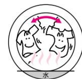
乾燥終了前に冷却水を貯めて余熱でスチームを出し、静電気を抑えてふんわりと仕上げます。
