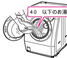
上記の処置をしても、給水運転時に洗剤投入ケースなどから水があふれる場合は本体内部のホース内の水が凍結していますので、乾燥運転を30分行った後運転してください。
